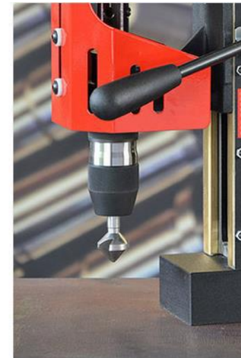
Portabrocas (requiere adaptador con vástago Weldon 13mm)
