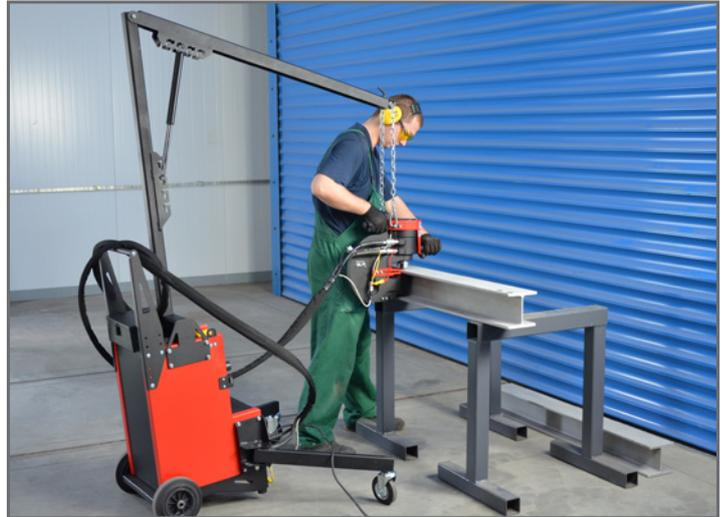
Brazo de izado y 2 soportes con ruedas permiten una manipulación sencilla del punzonado y el equipo de potencia en un solo conjunto
