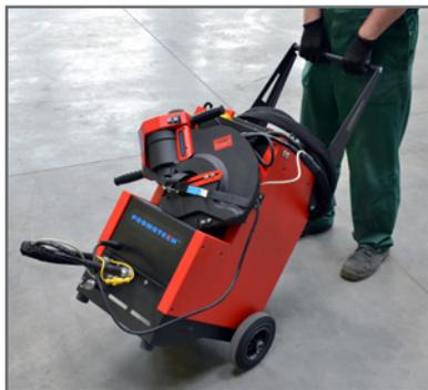
Paquete de Potencia Hidráulico auto-portátil para transporte.
