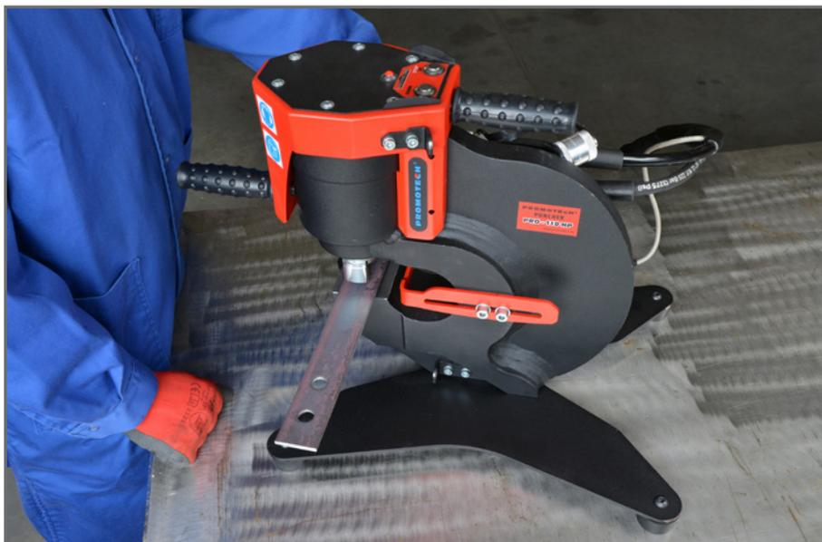
Ni la balanza ni el brazo de izado son necesarios para mantener la punzonadora en su sitio. Un operario puede usar el equipo con los botones del cuadro o con el pedal.
